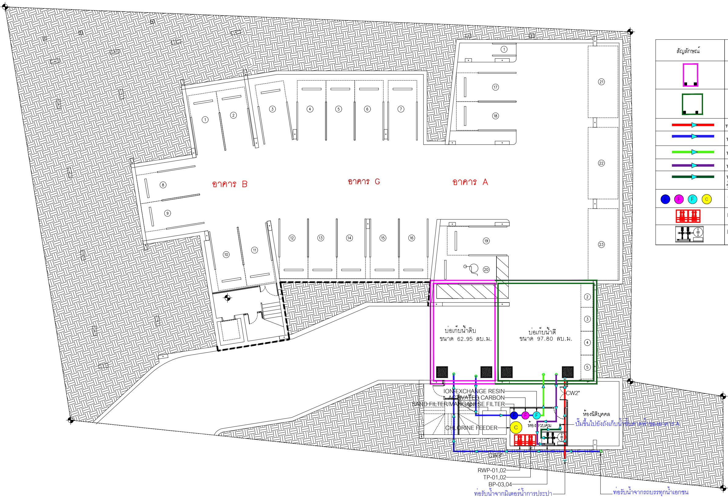
รูปที่ 2.8.2-1 แผนผังน้ำใช้ภายในโครงการ
