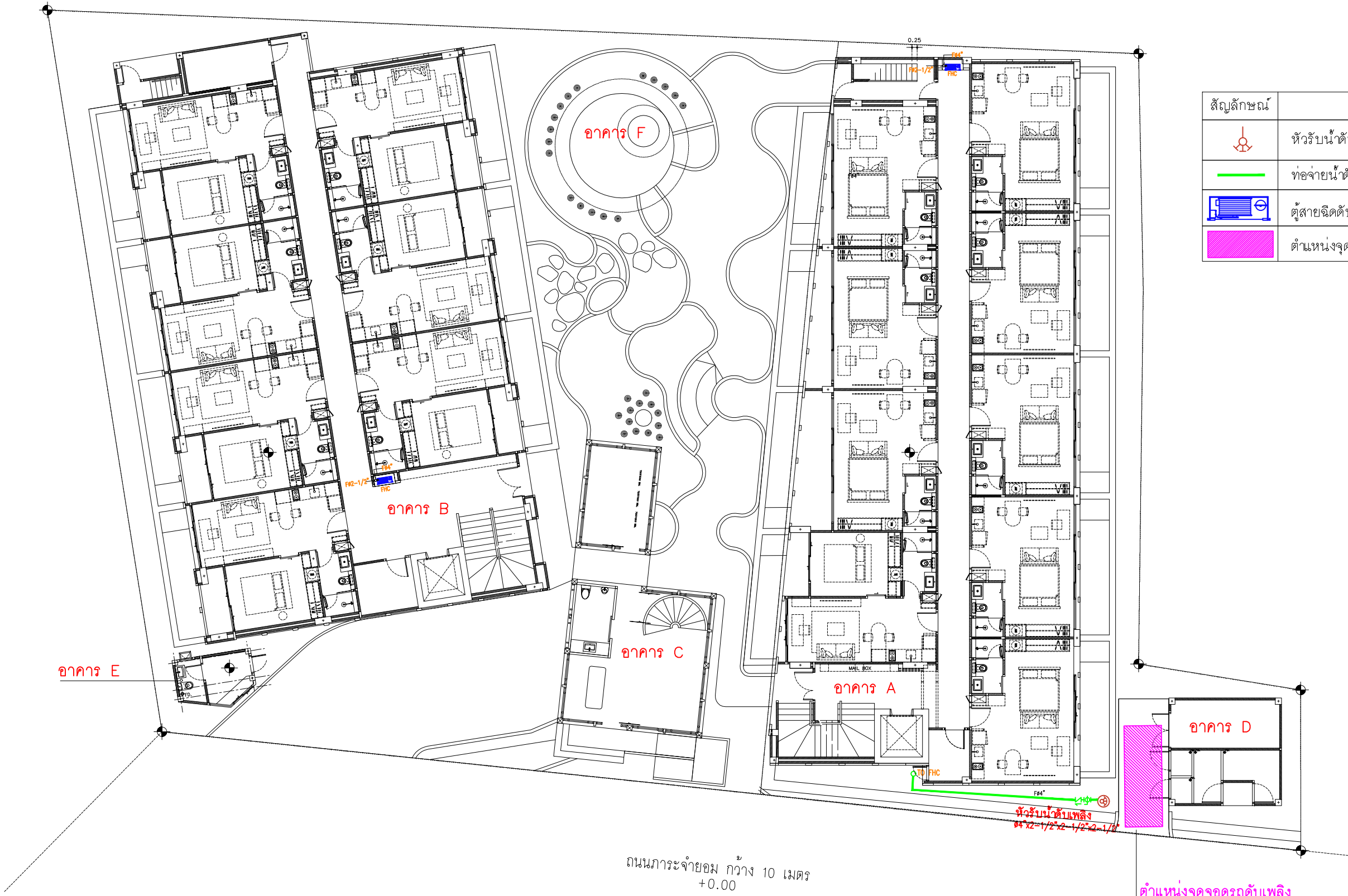
รูปที่ 2.9.2-1 ผังตำแหน่งหัวรับน้ำดับเพลิงและตำแหน่งจุดจอตดับเพลิง
