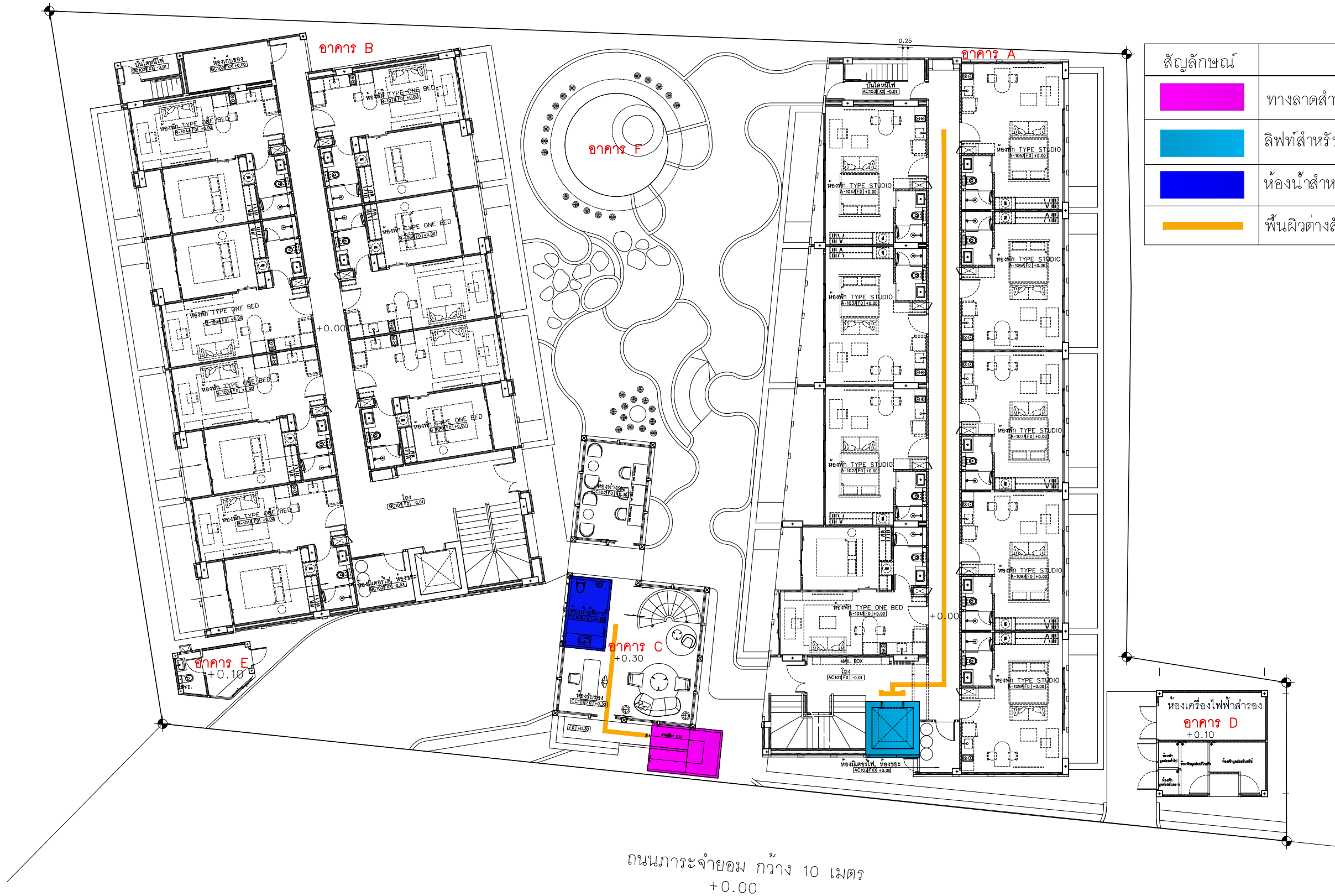
รูปที่ 2.6.2-2 ผังตำแหน่งสิ่งอำนวยความสะดวกสำหรับผู้พิการหรือทุพพลภาพ และคนชรา บริเวณชั้น 1
