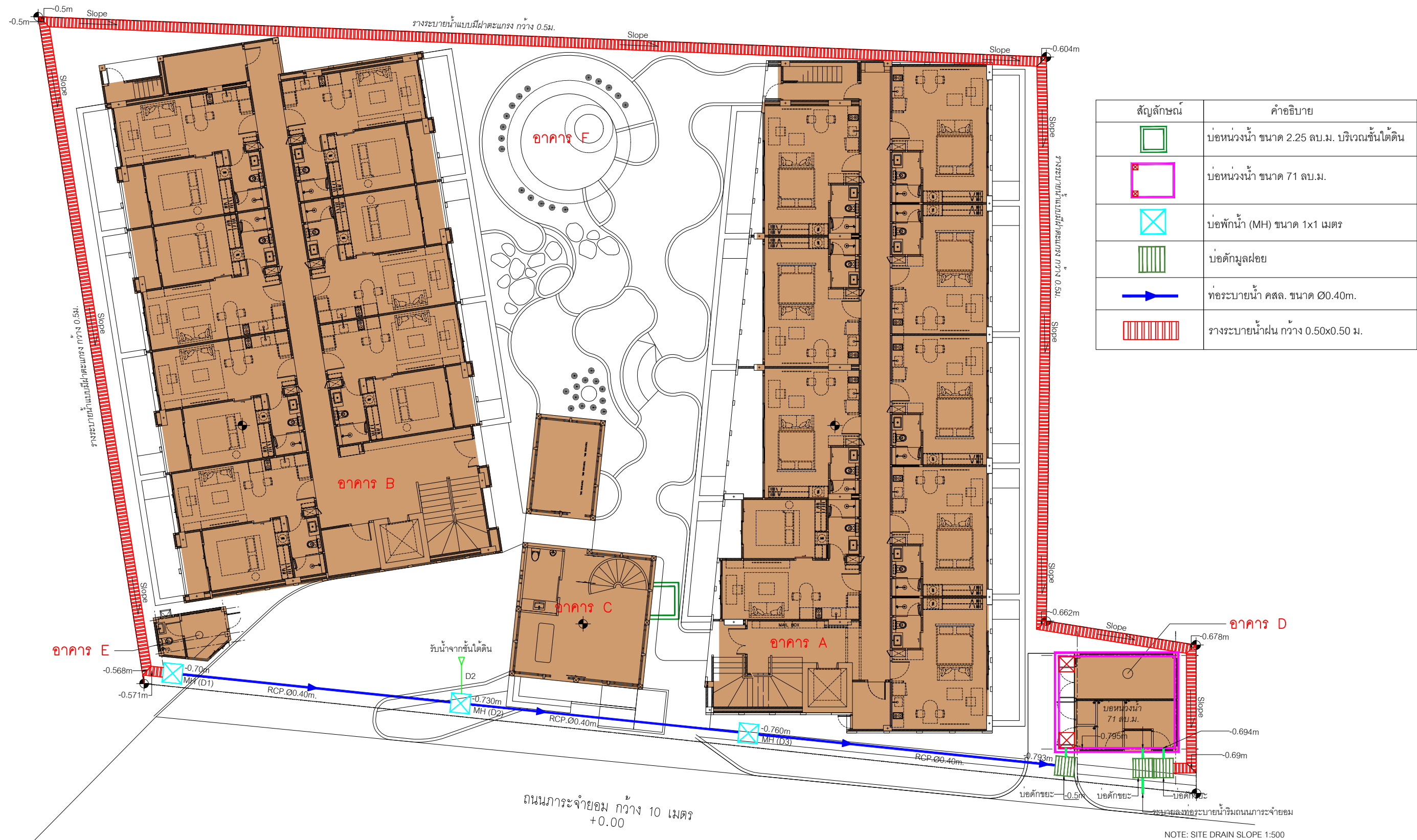
รูปที่ 2.8.3-2 ผังระบบระบายน้ำฝนและตำแหน่งบ่อน้ำฝนบริเวณชั้น 1
